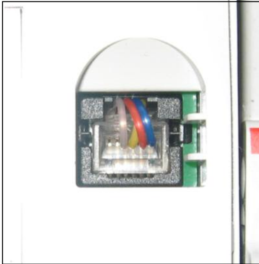
Рисунок 4. Внешний вид спереди на установленный разъем кабеля в гнезде RS232 контроллера со снятой передней крышкой. Скрытое подключение.
